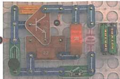
Рис. 2.6. Охранная сигнализация на герконе
